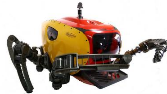
그림 1. 다관절 해저 보행 로봇 – 크랩스터(CR200).
