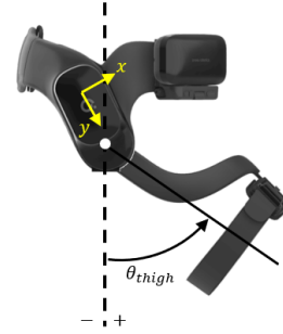
그림 2. KIT H10의 내부 센서 좌표계 및 고관절 각도 방향 정의. Fig. 2. Definition of the inertial sensor coordinate system and hip joint angle direction of the KIT H10.
