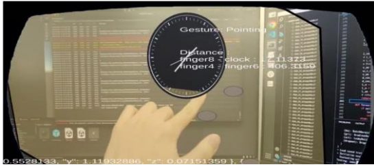
그림 4. AR Foundation[10]을 사용하여 평면 탐지(노란 영역) 및 가상 객체(시계) 고정.
