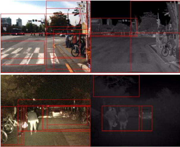
그림 4. Selective Search 적용 결과 시각화. (왼쪽) 컬러 영상 및 제안 영역 P_C , (오른쪽) 열화상 영상 및 제안 영역 P_T . 제안된 영역 P_C , P_T 는 빨간 박스로 나타내었다.
