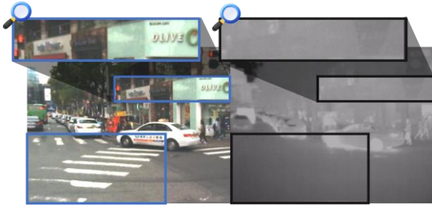
그림 1. 동일 주행 장면에 대한 모달리티 별 정보 비교 도식. (왼쪽) 컬러 영상, (오른쪽) 열화상 영상. 열화상 영상에는 사물의 색상, 질감과 같은 맥락적 정보가 부족하다.
