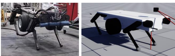
그림 3. (좌) 실물 로봇. (우) 시뮬레이션 로봇. Fig. 3. (Left) Quadruped robot. (Right) Simulation robot.
