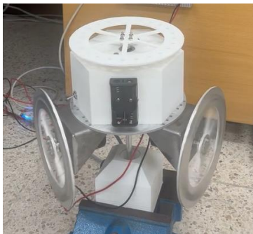
그림 6. 3차원 역진자 제어 실험. Fig. 6. Experiment of 3D inverted pendulum control.
