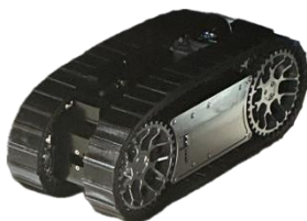
그림 5. 실험에 사용된 협소공간 주행로봇. Fig. 5. Narrow-space navigation robot used in the experiment.
