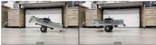
그림 8. Swing-up 모션과 균형제어 실험. Fig. 8. Swing-up and balancing experiment.
