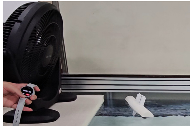
그림 16. 시험평가 수행(서브헬 안정성). Fig. 16. Execution of test and evaluation (subhull stability).
